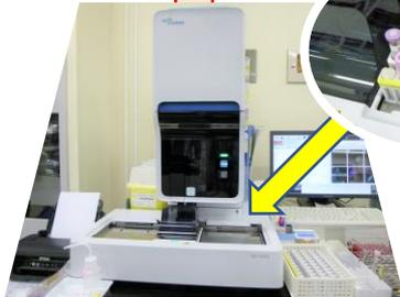
専用ラックに入れて血球測定装置にセットします
