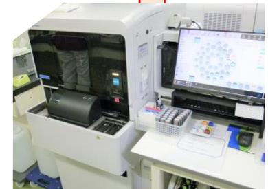
血漿を凝固測定装置にセットします
